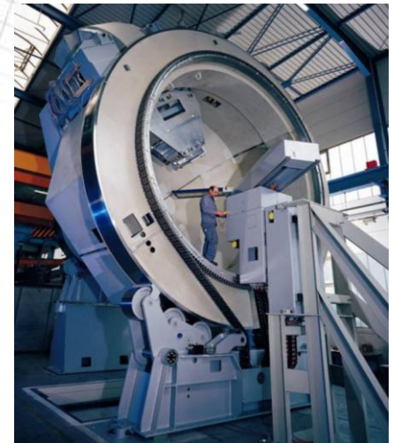
Gantry im Werk (150 t)
